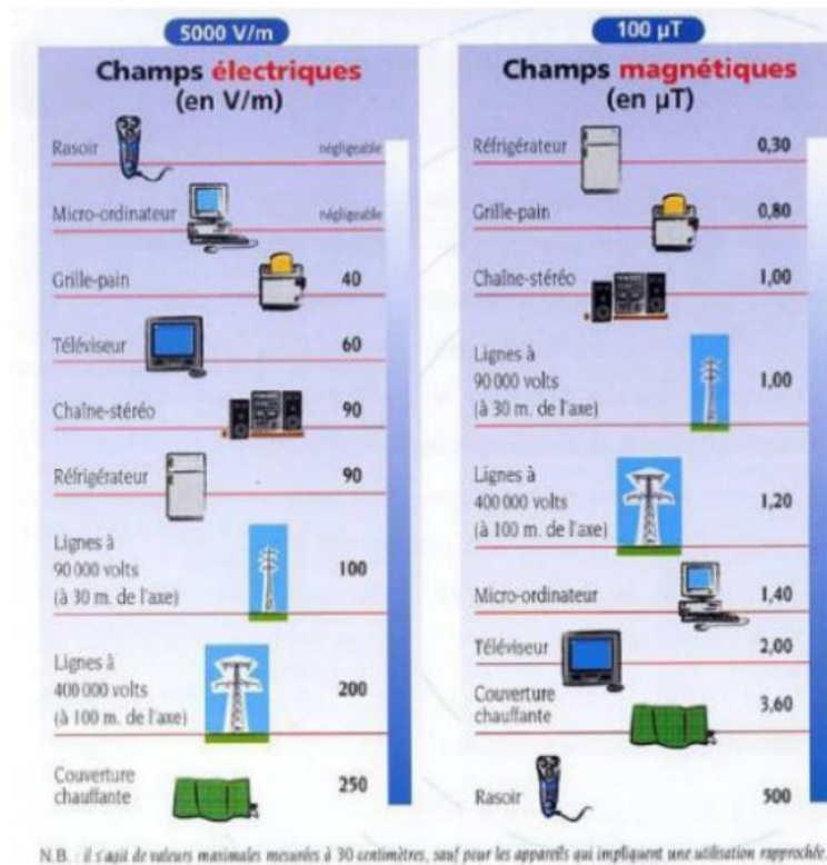
Comparaison entre champs électriques et champs magnétiques (source : RTE)
